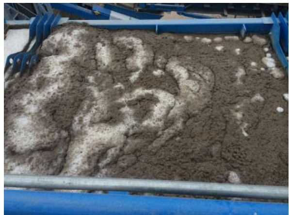
Stufe II: Zugabe von Flockungsmittel
